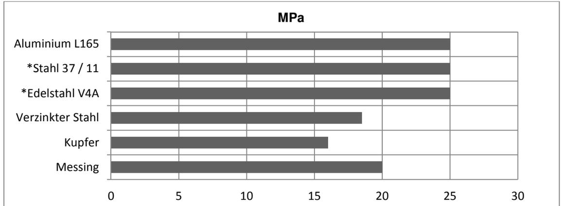
\* Prüfung mit 0,25 mm dicke Klebfuge. Die Leistung könnte mit dünnerer Klebfuge niedriger sein
